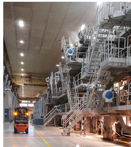
Varkauden pakkauskartonkitehtaan paperikone 3 valmistaa aaltopahvin raaka-aineita; kraftline-reita ja white top -linereita. Linereita käytetään aaltopahvin pinta- ja taustakerroksissa.
