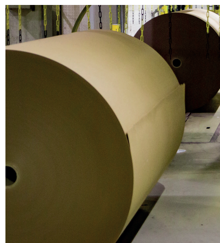
Kraftliner-rollat menevät kuljetinta pitkin tuotevarastoon.
