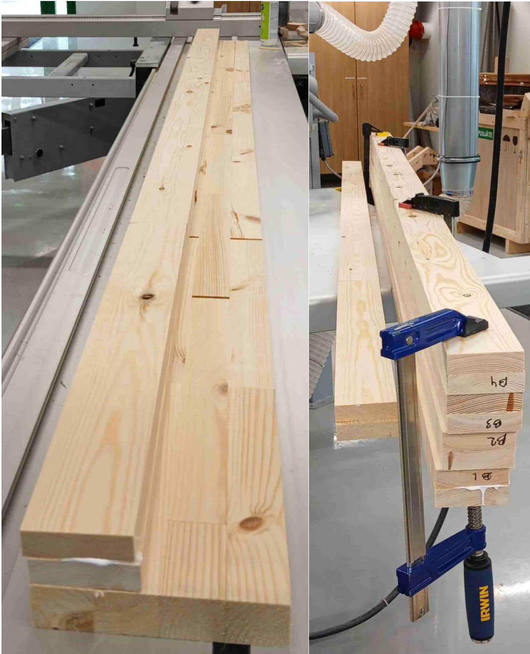
Kuva 6. Liimaten ja naulaten valmistetut väliseinätolpat – asetelma missä listanaulaus ja kevyt puristus tehtiin
