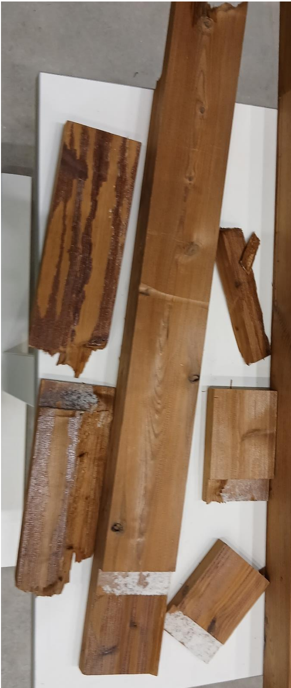
Kuva 12 Puristustestissä hajonnut lämpöpuusta valmistettu tolppa.
