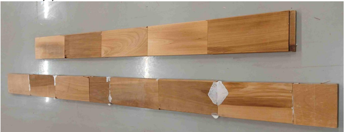
Kuva 3. Yhdistelmätolpan pintaosat ponttauksen ja liimauksen jälkeen ennen höyläystä
