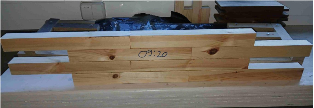
Kuva 1. Yhdistelmätolpan keskiosan havainnekuva osioiden porrastuksesta
