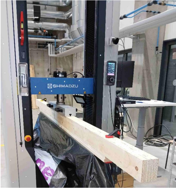
Kuva 4. Väliseinätolpan liimaus puristaen
