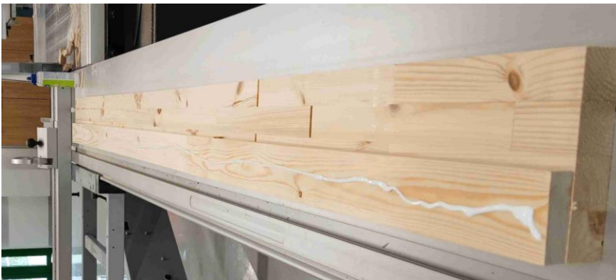
Kuva 5. Väliseinätolpan valmistaminen liimaten ja naulaten – kuva liimanlevityksen jälkeen
