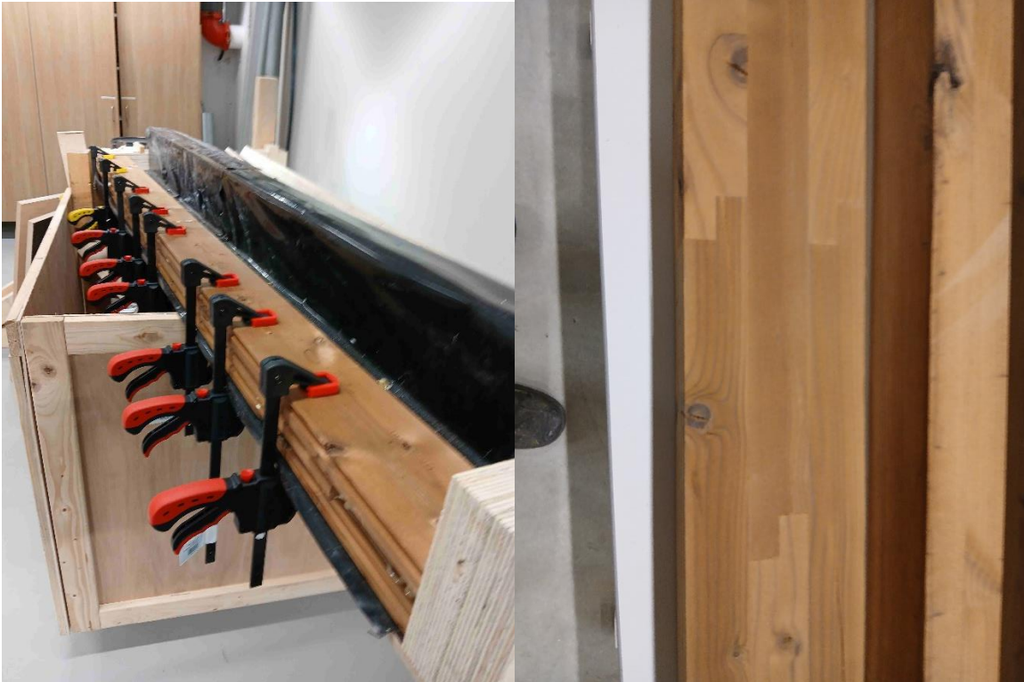
Kuva 7. Tolppien(2-kerros) ja pilarien(3-kerros) valmistaminen lämpöpuusta, prosessi sama.
